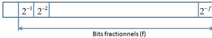
FIGURE 2.3 – Représentation d'un signal en virgule fixe avec une dynamique [-1, 1]
