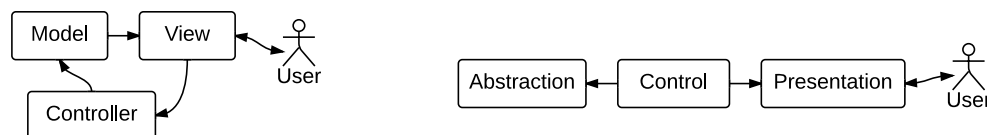
FIGURE 2.1 – Les modèles MVC (à gauche) et PAC (à droite)
