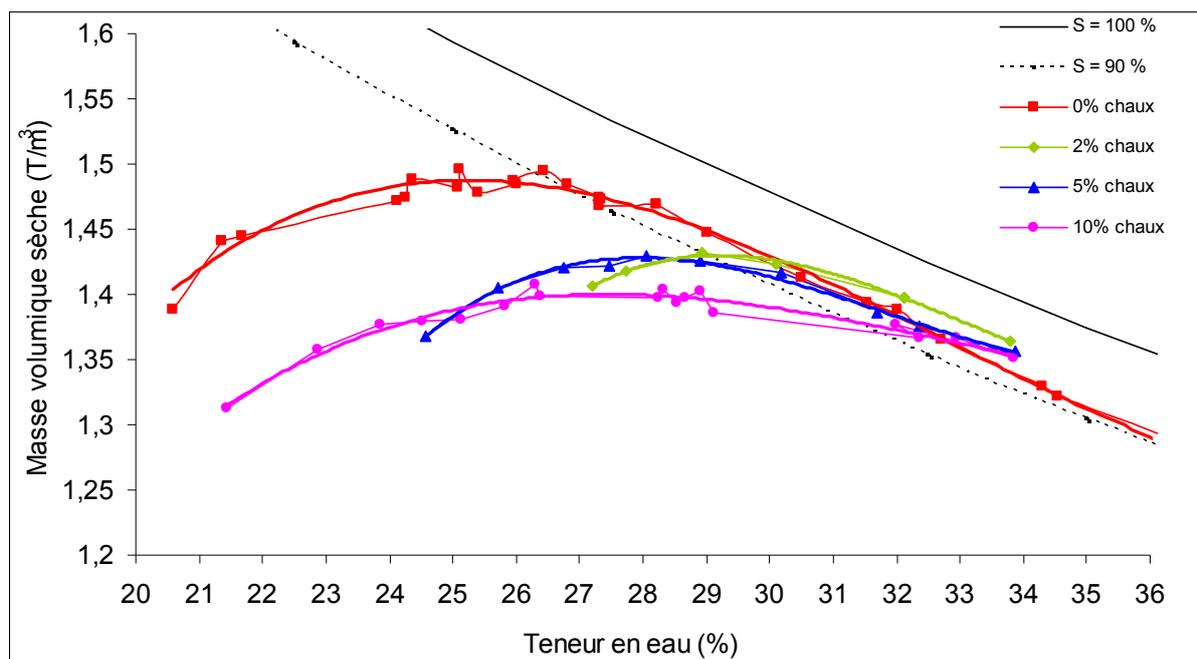
Figure II- 14 : Courbes Proctor de la kaolinite Polwhite non traitée et traitée avec 2, 5 et 10% de chaux ; La courbe de saturation  $S = 100\%$  indique la teneur en eau pour laquelle tous les vides du matériau sont remplis d'eau. ( $S = 90\% \rightarrow 90\%$  des vides sont remplis)
