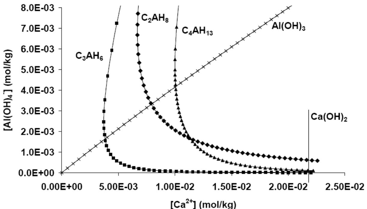
Figure I- 20 : Courbes de solubilités de Al(OH)<sub>3</sub>, C<sub>2</sub>AH<sub>8</sub>, C<sub>4</sub>AH<sub>13</sub>, C<sub>3</sub>AH<sub>6</sub> et Ca(OH)<sub>2</sub>
