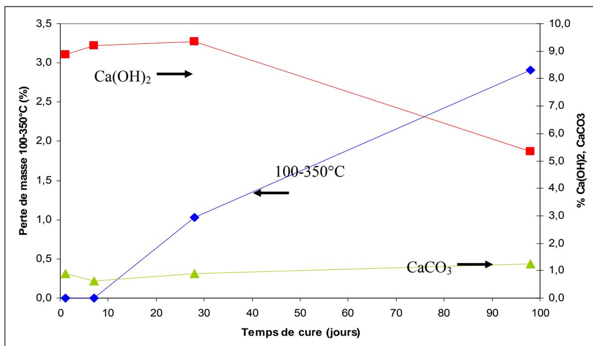
**Figure IV- 45 :** Evolution de la portlandite ( $\text{Ca}(\text{OH})_2$ ), de la calcite ( $\text{CaCO}_3$ ) et de la perte de masse 100-350°C caractéristique de composés hydratés (CAH-CSH) en fonction du temps pour la kaolinite traitée avec 10% de chaux à 20°C.
