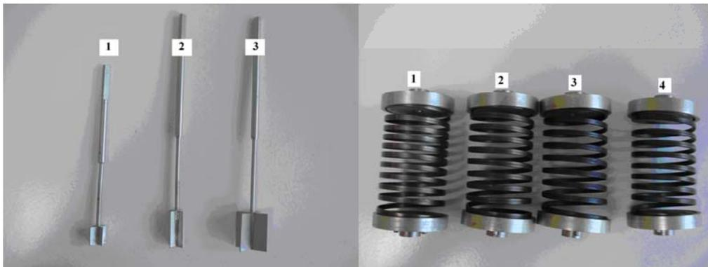
**Figure II- 17 : Moulinets et ressorts du scissomètre**
