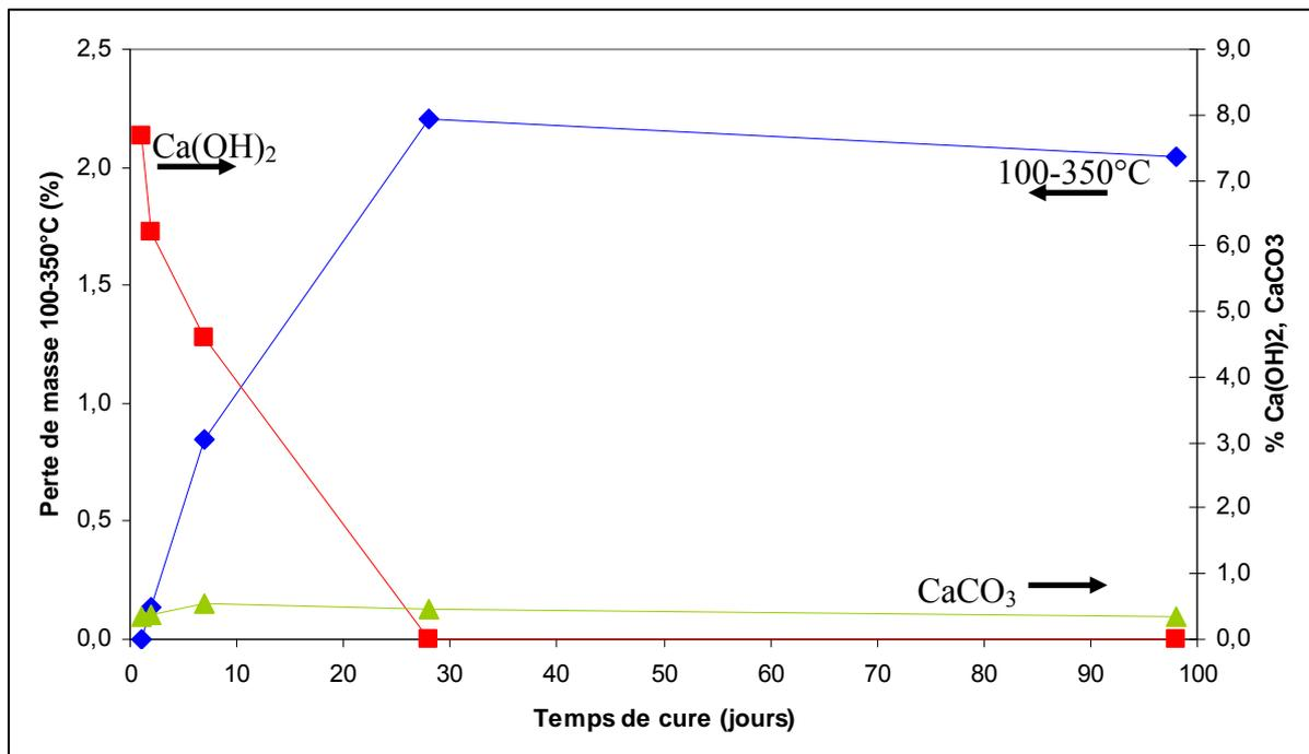
Figure IV- 46 : Evolution de la portlandite ( $Ca(OH)_2$ ), de la calcite ( $CaCO_3$ ) et de la perte de masse 100-350°C caractéristique de composés hydratés (CAH-CSH) en fonction du temps pour la kaolinite traitée avec 10% de chaux à 50°C.
