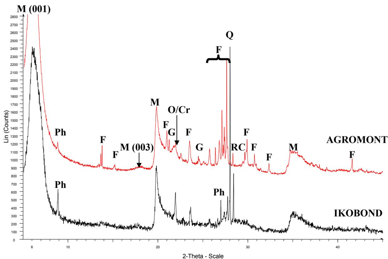
**Figure IV- 49 : Diffractogrammes de rayons X de la bentonite IKOBOND (étude mécanique) et la bentonite AGROMONT (étude en milieu dilué). M = Montmorillonite; Ph = Phlogopite; F = Feldspath ; Q = Quartz; O =Opale Cr = Cristobalite ; R = Rutile ; C = Calcite ; G = Goethite**
