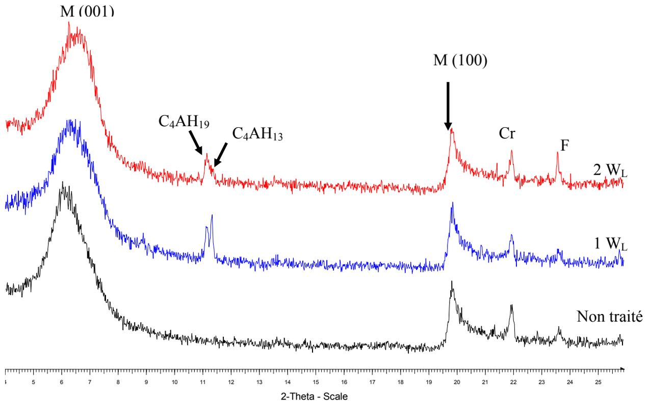
Figure IV- 23 : Diffractogrammes de rayons X des échantillons de pâtes de bentonite traitées à 10% pendant 98 jours, préparées à 1 et 2W<sub>L</sub>. M = Montmorillonite ; Cr = Cristobalite; F = Feldspaths
