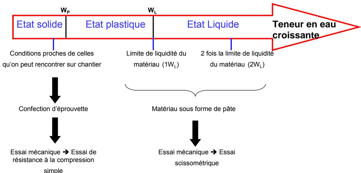
**Figure II- 12 : Schéma des différentes conditions de traitement des matériaux en fonction de la teneur en eau.  $W_p$  = limite de plasticité,  $W_L$  = limite de liquidité**
