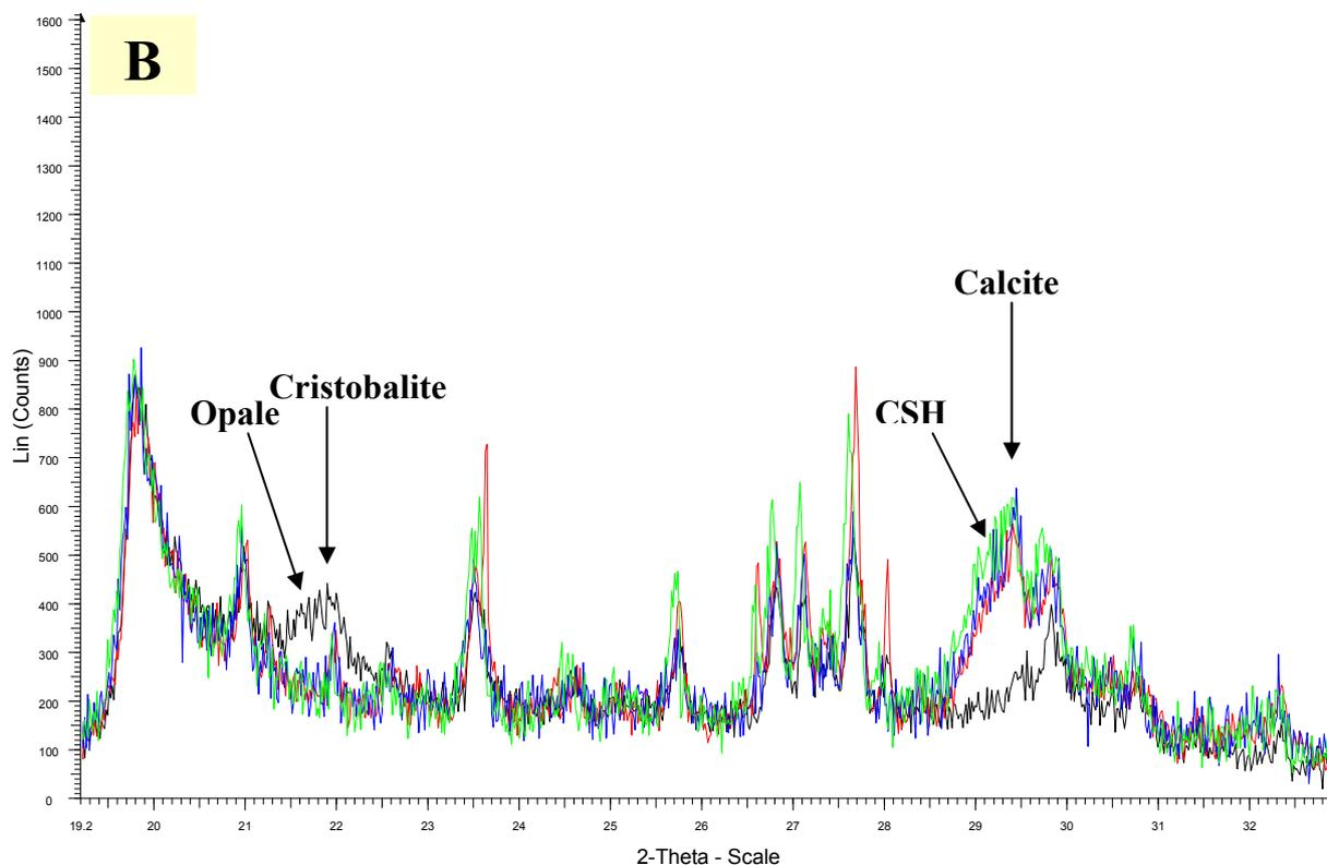
Figure IV- 57 : Diffractogrammes de rayons X du matériau brut et du matériau traité avec 10% de chaux pendant 7, 28 et 98 jours en suspension (L/S = 10) à 50°C (A) ; Agrandissement de l'intervalle 19-33°2θ (B). M = Montmorillonite ; F = Feldspaths ; G = Goethite ; O = Opale ; Cr = Cristobalite
