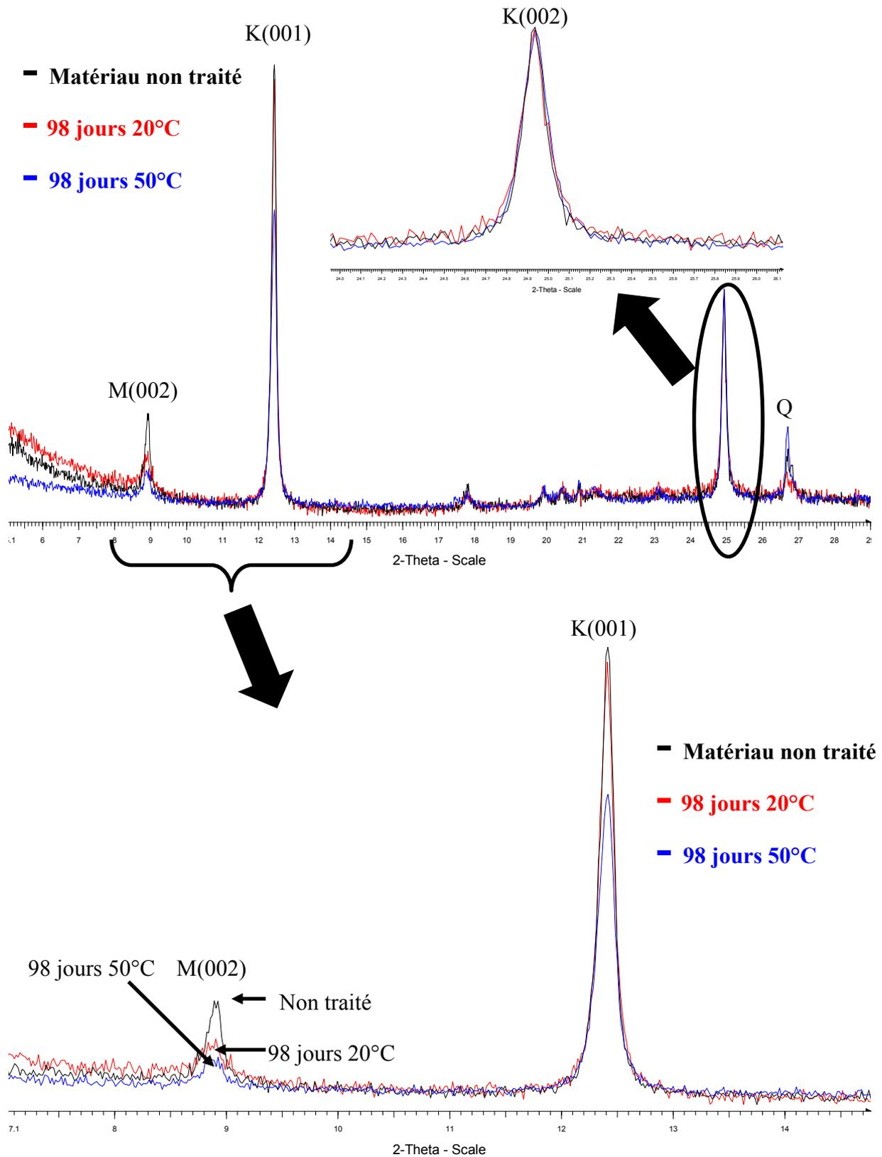
Figure IV- 3 : Diffractogrammes de rayons X sur lame de kaolinite Polwhite traitée avec 10% de chaux pendant 98 jours à 20 et 50°C, K = Kaolinite ; M = Muscovite ; Q = Quartz
