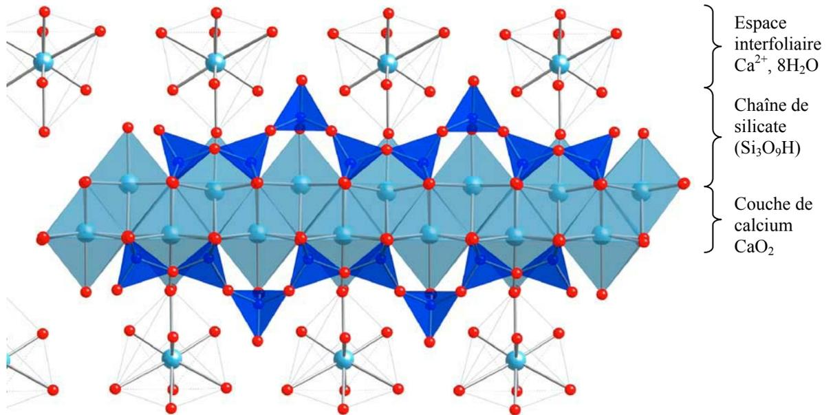
Figure I- 17 : Structure de la tobermorite (Richardson, 2004)
