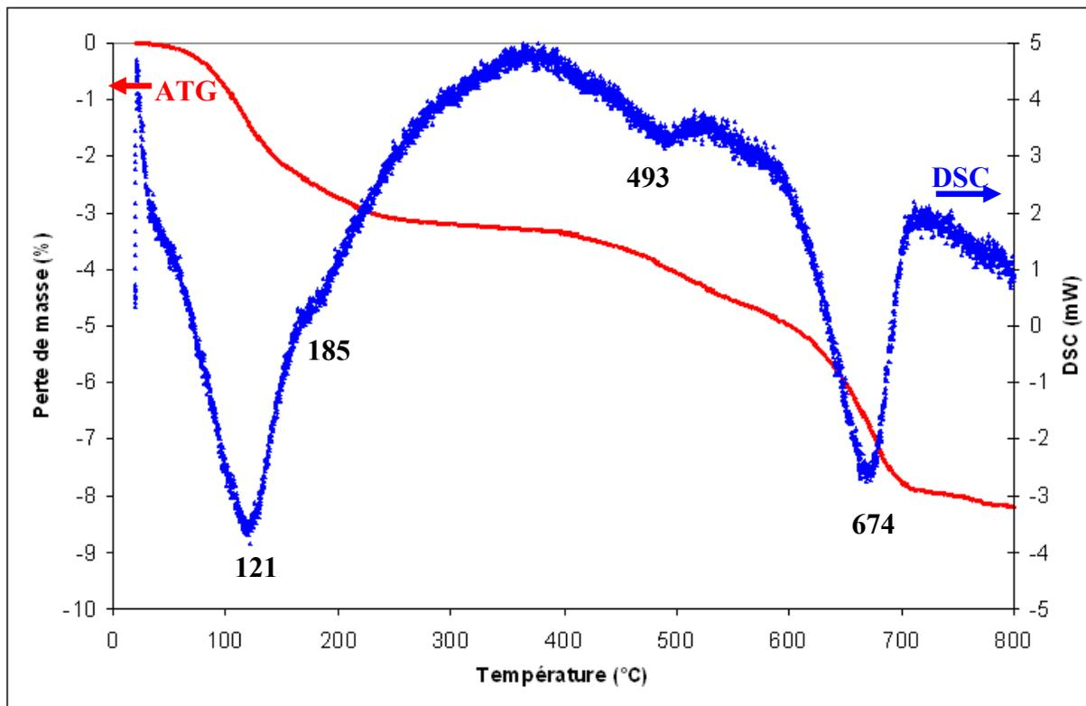
Figure IV- 24 : Analyses thermiques (ATG/DSC) de la bentonite calcique Ikobond
