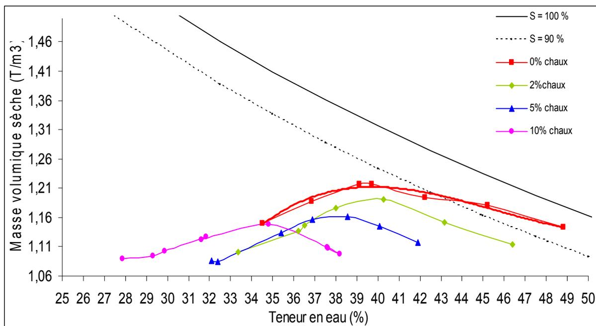
Figure II- 15 : Courbes Proctor de la bentonite calcique Ikobond non traitée et traitée avec 2, 5 et 10% de chaux. La courbe de saturation  $S = 100\%$  indique la teneur en eau pour laquelle tous les vides du matériau sont remplis d'eau. ( $S = 90\% \rightarrow 90\%$  des vides sont remplis)
