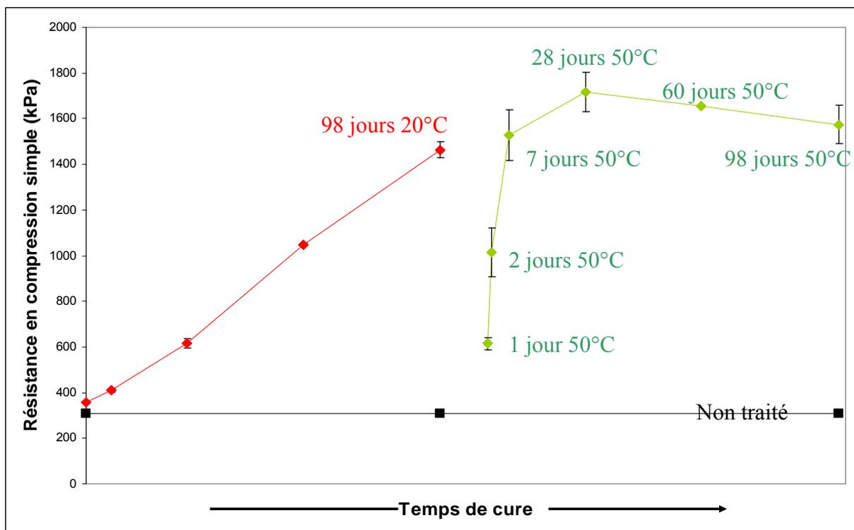
Figure V- 7 : Evolution de la résistance en compression simple de la bentonite calcique traitée avec 10% de chaux, en fonction du temps de cure.
