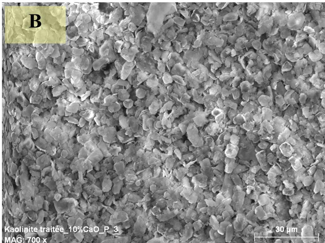
Figure IV- 47 : Microstructure de la kaolinite Polwhite avant (A) et après (B) un traitement de 10% de chaux pendant 98 jours à 20°C, en suspension. Grossissement x 700
