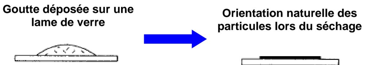
**Figure II- 19 : Réalisation d'une lame orientée**
