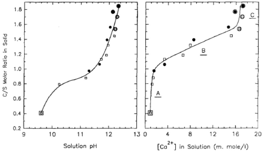
**Figure I- 15 :** Evolution du rapport C/S des silicates de calcium hydratés en fonction du pH (à gauche) et de la concentration en calcium  $\text{Ca}^{2+}$  en solution (à droite) (Cong and Kirkpatrick, 1996b)
