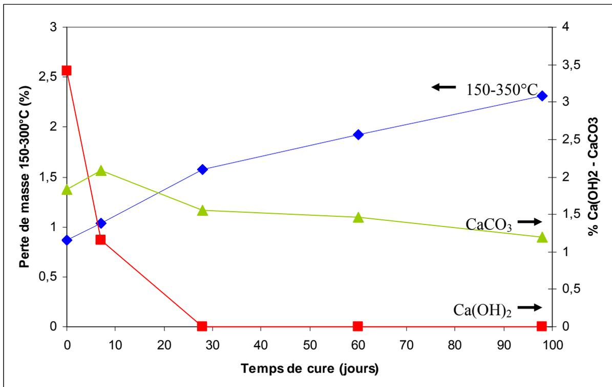
Figure IV- 26 : Evolution de la perte de masse entre 150 et 350°C, de la portlandite (Ca(OH)<sub>2</sub>) et de la calcite (CaCO<sub>3</sub>) en fonction du temps pour les éprouvettes de bentonite calcaïque traitées avec 10% de chaux et conservées à 20°C
