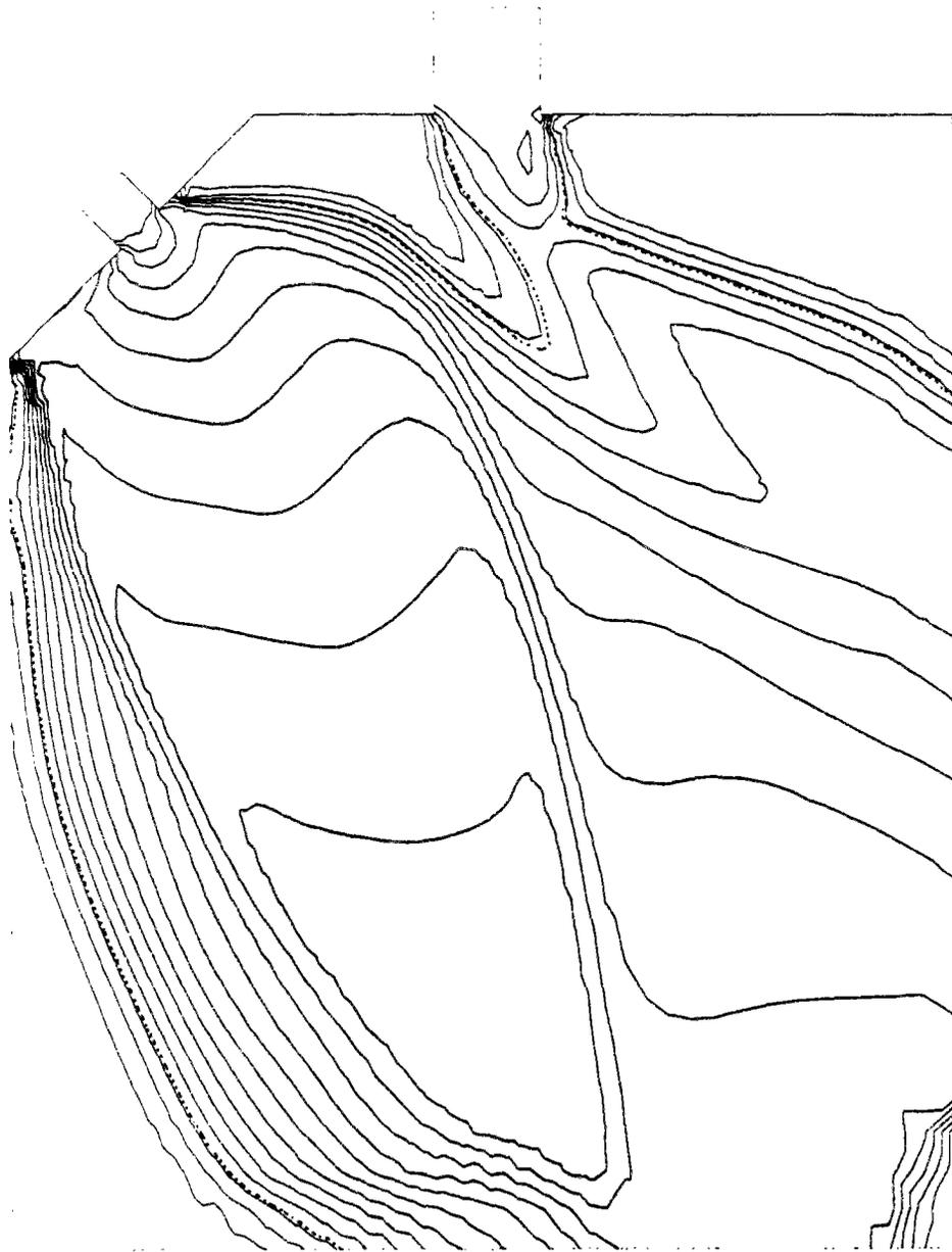
Figure IV.9 : Lignes Isomach obtenues avec le flux de Steger et Warming modifié
