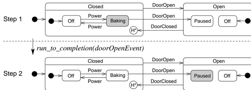
Figure 1. Exemple d'exécution d'une machine à états UML
