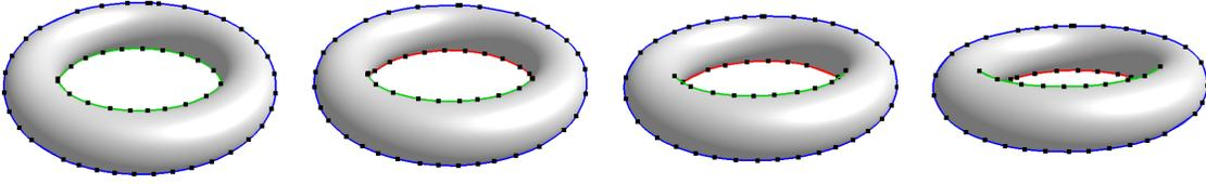
Figure 6: Lissage temporellement cohérent en utilisant des splines cubiques d'Hermite. Noter la propagation des points de contrôle (carrés noirs) y compris durant les changements topologiques.
