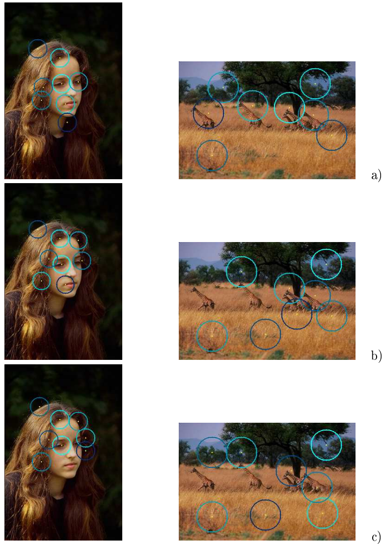
FIG. C.2 – a) Résultats obtenus en ne considérant que les caractéristiques de contraste et d'orientations; b) Résultats obtenus avec la méthode Itti; c) Résultats obtenus en donnant deux fois plus d'importance aux couleurs qu'au contraste et à l'orientation, c) Résultats obtenus en donnant deux fois plus d'importance aux couleurs
