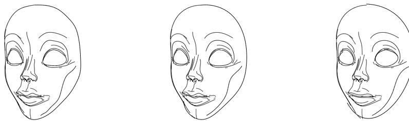
FIG. 3.3 – Lignes lissées pour des valeurs de 5, 10 et 20 du rapport entre le nombre d'échantillons et le nombre de points de contrôles.
