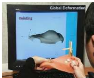
Figure 2.4. Les déformations appliquées sur l'avatar sont répercutées sur le modèle 3D virtuel
