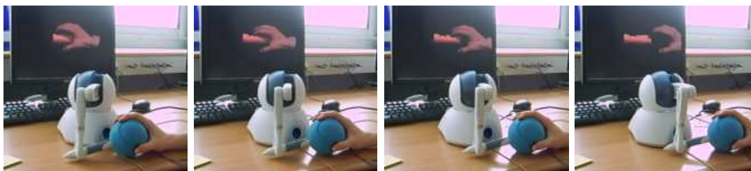
Figure 7.1. Déplacement horizontal de la main virtuelle en fonction de celui du Phantom sur la table
