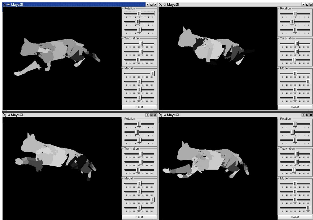
FIG. 5.12 – La visualisation en OpenGL du modèle. Toutes les configurations du mouvement peuvent être décrites avec 10 paramètres
