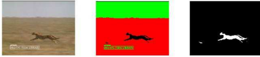
FIG. 4.1 – La segmentation par couleur. Les couleurs proches sont d’abord regroupées en paquets ( clusters ), puis la couleur de l’animal est séparée des autres.
