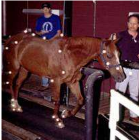
FIG. 2.1 – un exemple de capture de mouvement sur les animaux à l'aide de marqueurs optiques.
