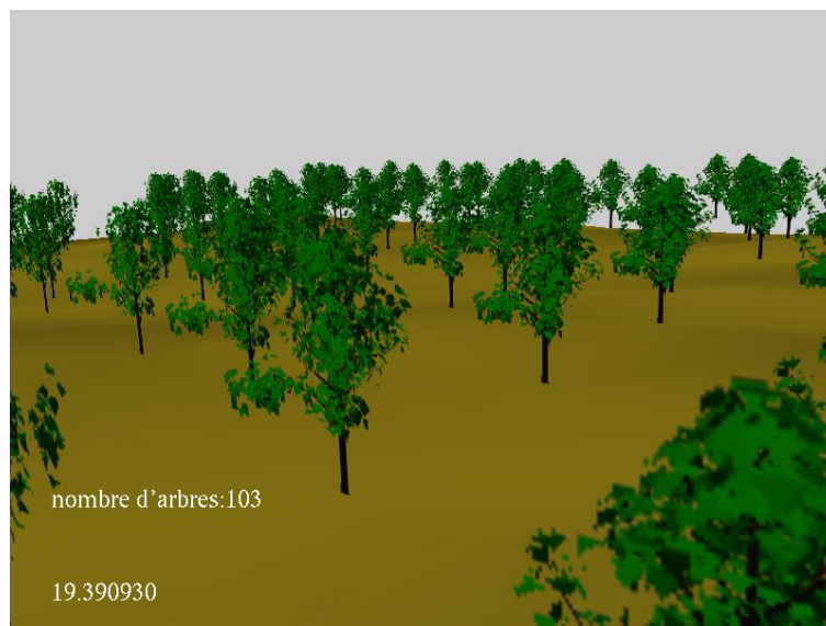
FIG. 6.4 – Les texels permettent de faire un rendu de forêt dans une résolution 800x600 en temps réel (20 fps) avec 100 arbres à l'écran avec un niveau de détail intermédiaire
