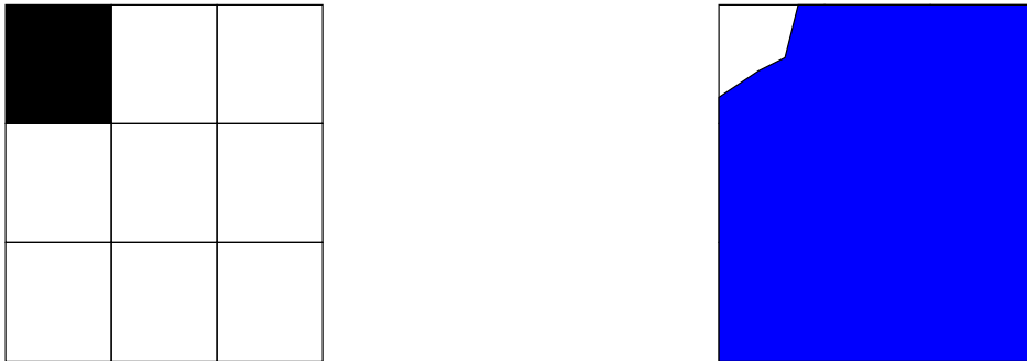
FIG. 5.1 – A gauche, un seul pixel a une opacité nulle et sa couleur, non définie, est nulle. En foncé, à gauche, la zone rendue lors de l'affichage du texel . Le résultat de l'interpolation est que le mélange des couleurs va se faire tout de même avec les pixels de texture dont la couleur n'est pas définie. La solution consiste à corriger la couleur de cette cellule afin de minimiser l'erreur
