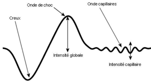
FIG. 3.1 – Le profil d’onde que nous avons choisi
