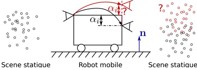
FIGURE 3 – Mouvement plan (cas singulier) : la hauteur relative  $\alpha_i$  entre les caméras (par rapport au plan du mouvement) n'est pas observable. Les observations ne changent pas entre le système réel (en noir) et estimé (en rouge).
