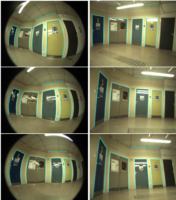
FIGURE 4 – Images fish-eyes et perspectives avec détection des droites
