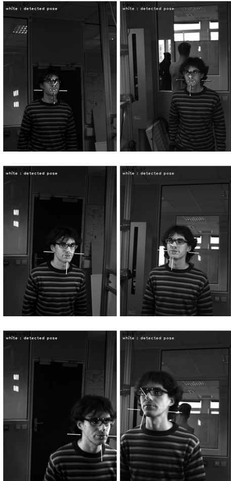
FIGURE 11 – Pose estimée avec le 2PF - 500 particules. Les axes caractérisent la pose estimée par l’algorithme de suivi et les points blancs correspondent aux projections des points caractéristiques associées à cette pose.
