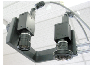
FIGURE 5 – Capteur stéréo mixte dans une seconde configuration avec la caméra fisheye sur la droite de l'image et la caméra perspective sur la gauche.
