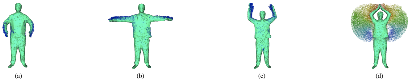
FIG. 7: Champs de déplacement sur certaines trames de nos données réelles, et historique du mouvement accumulé sur toute la séquence (les couleurs indiquent l'ancienneté du mouvement).
