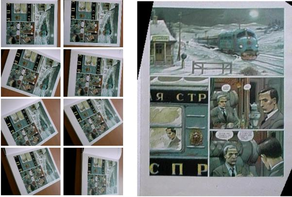
FIG. 6 – À gauche : images originales ; à droite : image rectifiée après autocalibrage plan, à partir des solution exactes données en §4.3
