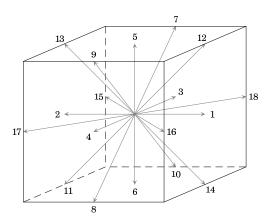
Fig. 1. The D3Q19 stencil
