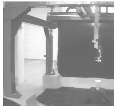
FIG. 14 – La sphère de vues est obtenue au moyen d'une caméra embarquée sur un bras robotique.
