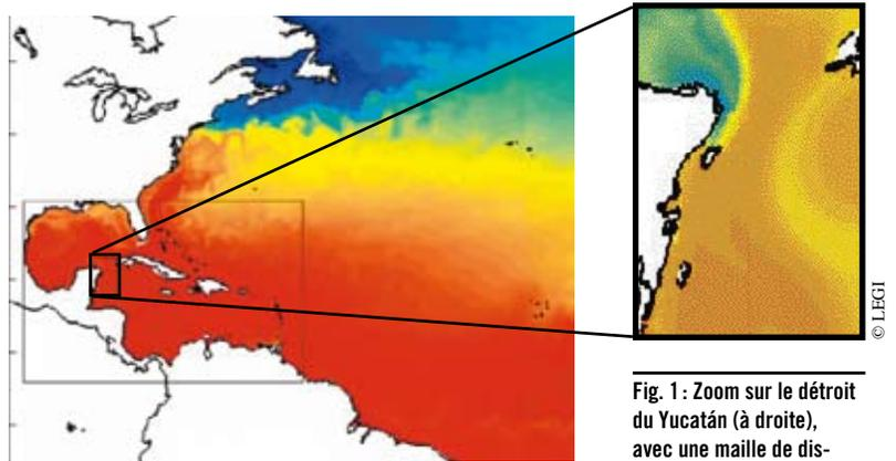
Fig. 1 : Zoom sur le détroit du Yucatán (à droite), avec une maille de discrétisation du modèle de circulation océanique de 4 km environ, tandis que la maille pour le modèle général de l'Atlantique (à gauche) est d'environ 35 km.
