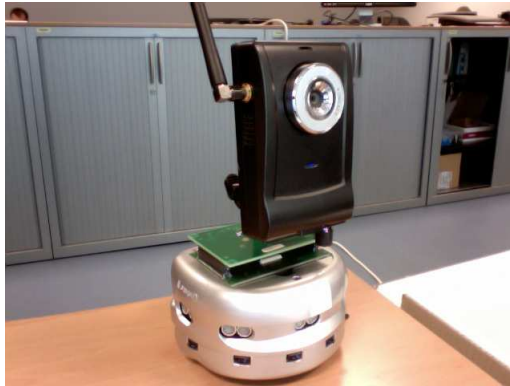
FIGURE 4.3 – Robot Khepera3 équipé de la caméra KorwlCam
