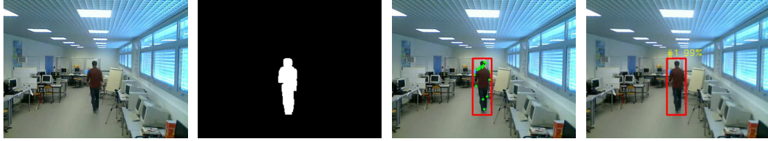
FIGURE 4: Illustration des différentes étapes mises en oeuvre pour la détection. De gauche à droite : image d'entrée, soustraction de l'arrière-plan, suivi et résultat final avec affichage de l'indice de confiance.
