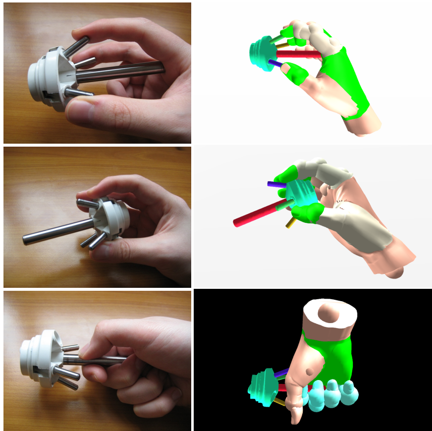
FIGURE 9: Différentes configurations possibles de la main et des doigts pour la saisie d'un porte-satellite.
