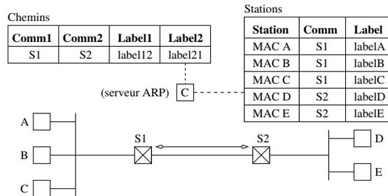
FIG. 4 – Gestion des labels dans le *contrôleur*
