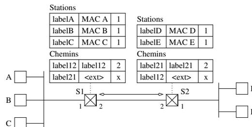
FIG. 5 – Gestion des labels dans les commutateurs
