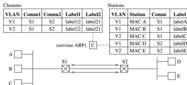
FIG. 6 – Implémentation des VLAN dans *LaidaNet*
