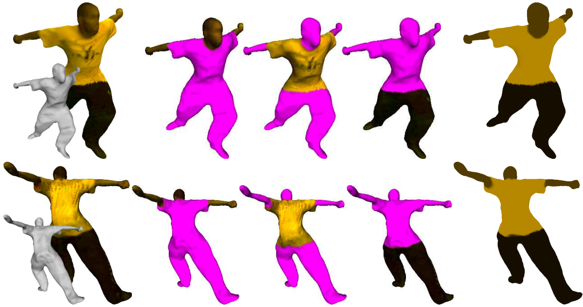
FIG. 8: Résultat de segmentation sur un maillage obtenu par stéréo multi-vues. Vue de face (ligne du haut) et de dos (bas). Maillage coloré original et la forme 3D associée (gauche). Résultat de la segmentation en trois région par notre approche (milieu). Valeurs moyennes pour chaque région segmentée (droite).
