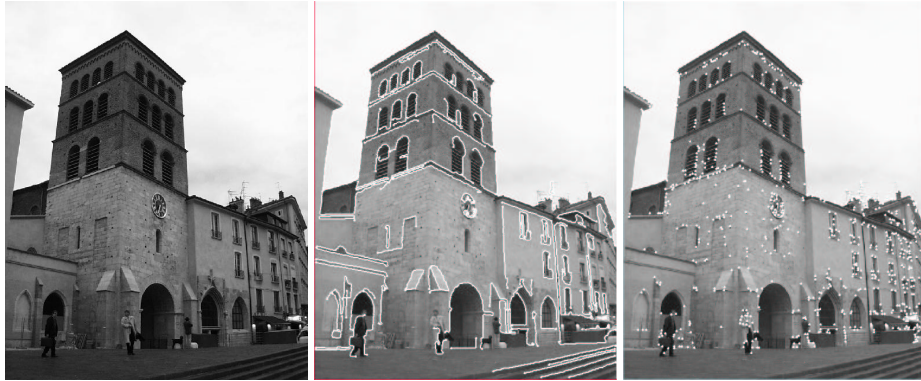
Figure 1.7. Une image, les contours extraits (filtre de Canny) et les points d'intérêt extraits (détecteur de Harris).
