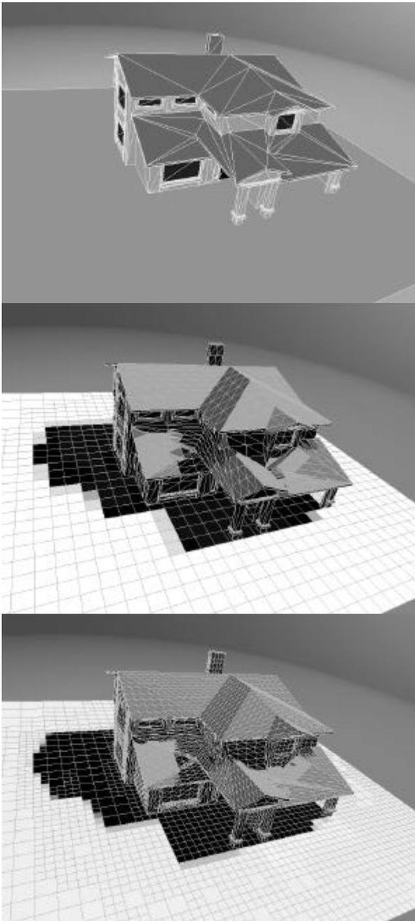
Figure 5. Exemple de scène mettant en évidence le raffinement automatique des objets par la méthode de radiosité. La première image montre le maillage original, les images suivantes le résultat du calcul de radiosité pour deux aires minimales de raffinement ( $1 \text{ m}^2$  et  $50 \times 50 \text{ cm}^2$ ).
