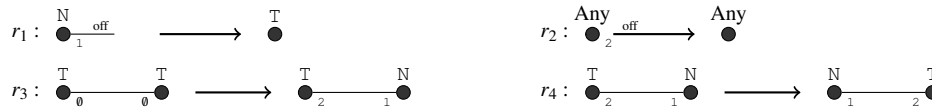
FIG. 1: L'algorithme de construction et de maintien d'une forêt couvrante sous la forme d'un ensemble de règle de réétiquetage.
