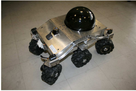
Fig. 2. La plate-forme Mines Rover. Nous pouvons voir sur la photo la coupole de la caméra, les servomoteurs de direction, le télémètre laser HOKUYO URG-04, le récepteur GPS (carré gris) et les capteurs à ultrasons d'urgence à l'avant du robot.
