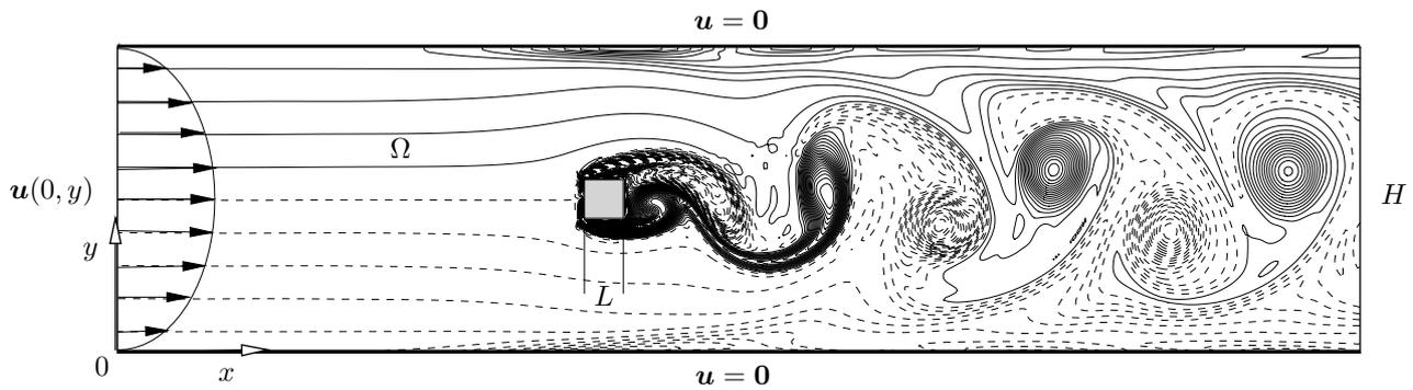
FIG. 1 – Configuration d'écoulement et champ de vorticité à  $Re = 200$ .
