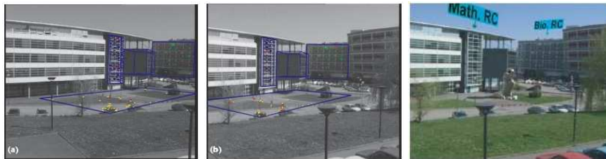
Figure 6. Réalité augmentée sans modèle : estimation en ligne du déplacement de la caméra en utilisant plusieurs plans (travaux réalisés au Loria par (Simon et al. , 2002a))
