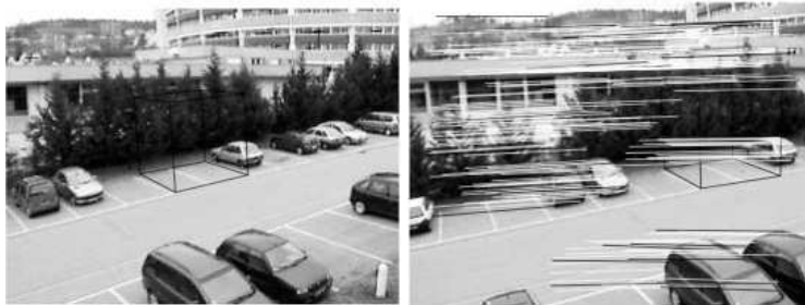
Figure 10. Exemple de suivi multicapteur : deux images successives de la séquence avec un mouvement brusque de la caméra. L'objet incrusté est un cube visible sur les deux images. La deuxième image montre aussi les mises en correspondance de point qu'il a été possible de réaliser grâce à la fusion de l'information vidéo et de la centrale inertielle (travaux réalisés au Loria par (Aron et al., 2007))
