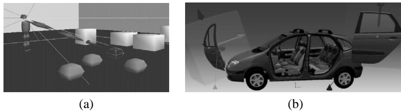
Figure 12. Illustration d'un objet sélectionné : il apparaît en fils de fer et se trouve au bout des bras de l'avatar de l'interacteur (Fraser et al., 1999). Sur (a), la sélection est montrée via des boîtes englobantes (Duval et al., 2004)
