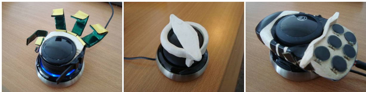
(a) La première forme inspirée de celle du prototype V2. (b) La deuxième forme inspirée de celle du SpaceNavigator™. (c) La troisième forme inspirée de celle d'une souris d'ordinateur.
