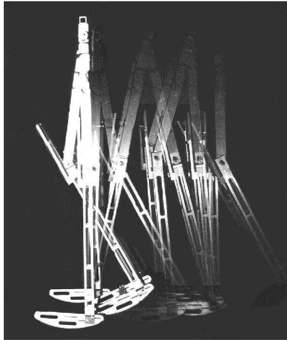
Figure 3 Un robot marcheur dynamique passif (Photo reprise de: <http://ruina.tam.cornell.edu/hplab/pdw.html>)
