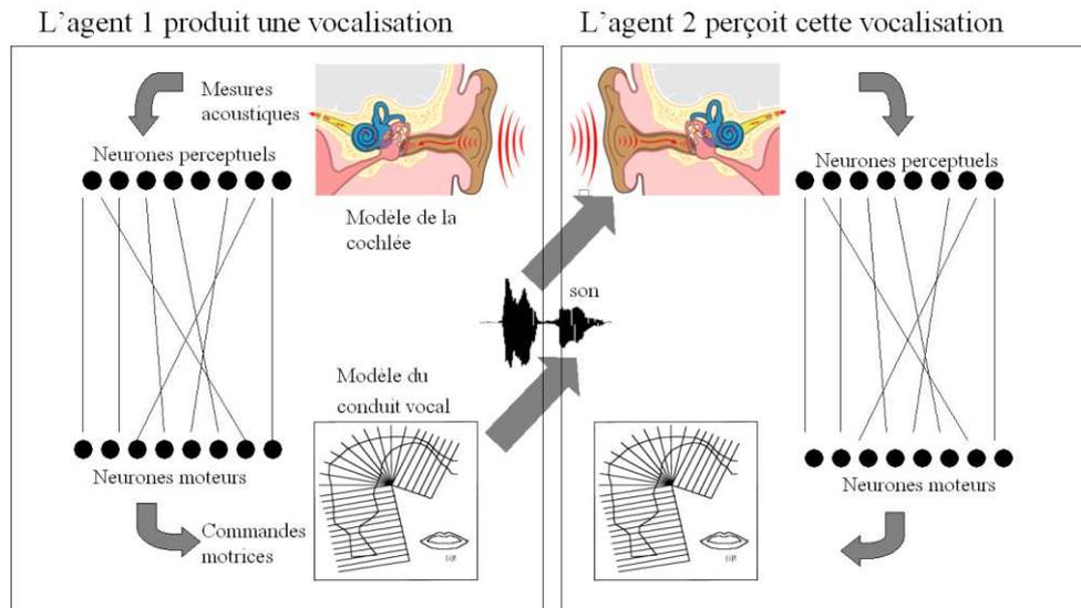
Figure 5 L'architecture des robots dans les expériences sur les origines des systèmes de vocalisations présentées dans (Oudeyer, 2006). Les agents sont dotés d'une oreille artificielle, d'un conduit vocal artificiel, et d'un cerveau artificiel qui couple ces deux organes. Les agents sont eux-mêmes couplés par l'environnement commun dans lequel ils évoluent : ils perçoivent les vocalisations de leurs voisins.
