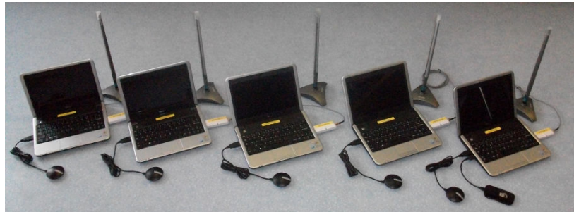
Figure 4. Plate-forme expérimentale composée de mini Dell sous Linux, de cartes WiFi externes, d'antennes externes et de GPS. Le Dell de droite dispose d'une carte 3G (connectiques USB).
