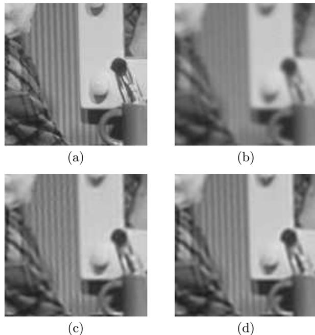
FIG. 1 – Restauration d'une image floue et bruitée : (a) image de référence, (b) image observée floue et bruitée (*PSNR* = 25.6 dB), (c) résultat du modèle de parcimonie (*PSNR* = 28.9 dB), et (d) résultat du modèle de régularité (*PSNR* = 29.1 dB).
