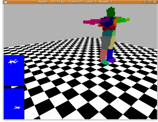
FIGURE 3 – skinning automatique de la posture de référence avec une couleur par os.
