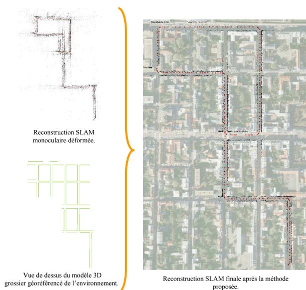
FIG. 1 – **Illustration de la méthode proposée.** Nous proposons de corriger la reconstruction SLAM initiale grâce à un modèle 3D de l'environnement. Le résultat obtenu est superposé à une image satellite.
