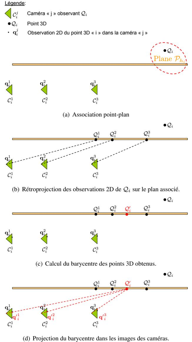
FIG. 3 – **Fonction de coût proposée.** Exemple d'un point 3D  $Q_i$  observé par 3 caméras. Les étapes successives sont décrites des sous-figures (a) à (d). Les résidus sont les distances 2D entre  $(q_i^j)_j$ , les observations de  $Q_i$ , et  $(q_i^{\prime j})_j$ , les projections de son point 3D associé  $Q'_i$ .
