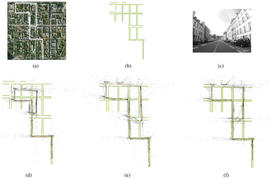
FIG. 5 – **Séquence de Versailles**. La première ligne présente les informations concernant la séquence réelle : la trajectoire suivie (a), le modèle 3D grossier (b) et une image issue de la vidéo traitée (c). La seconde ligne présente les différentes configurations de la reconstruction SLAM par rapport au modèle 3D : la reconstruction initiale avec l’algorithme de Mouragnon [10] (d), l’initialisation de la méthode ICP non-rigide (e) et le résultat de la méthode proposée (f).
