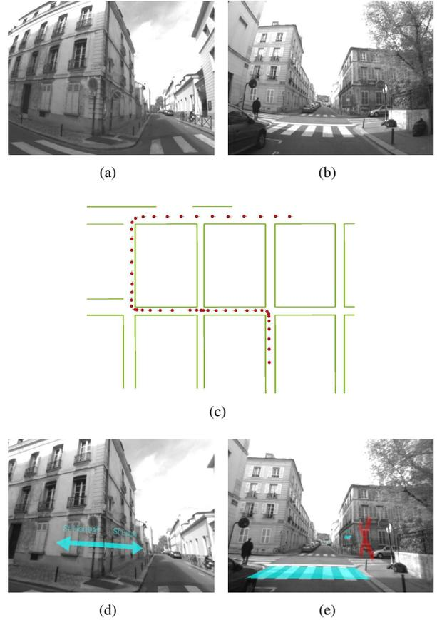
FIG. 7 – **Réalité augmentée sur les images localisées.** La première ligne donne deux exemples d'images de la nouvelle vidéo. (b) est le résultat de la localisation globale de plusieurs images. Les images (c) et (d) présentent des résultats de réalité augmentée sur les images (a) et (b).
