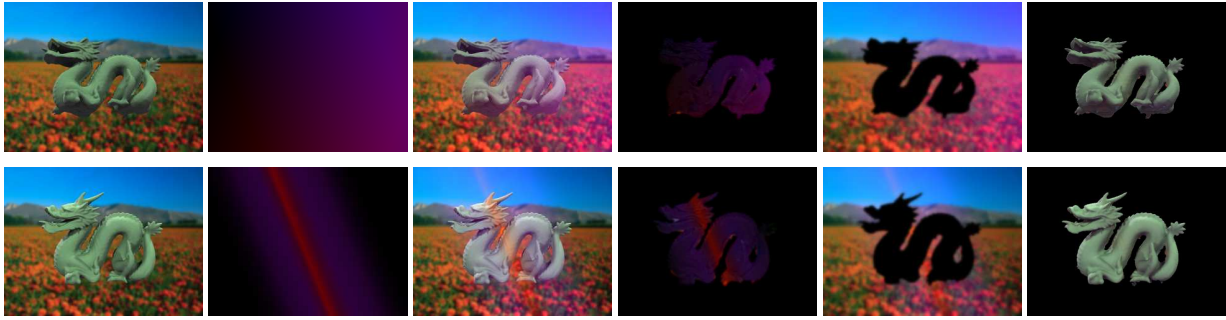
FIG. 4 – Séquence de synthèse "dragon". De gauche à droite : 2 des 32 images originelles ; composante ajoutée pour simulé des effets photométriques sur les caméras ; images d'entrée ; composante corrective estimée (multipliée par 2 pour la visualisation) ; image de fond estimée ; surface et radiance estimées.
