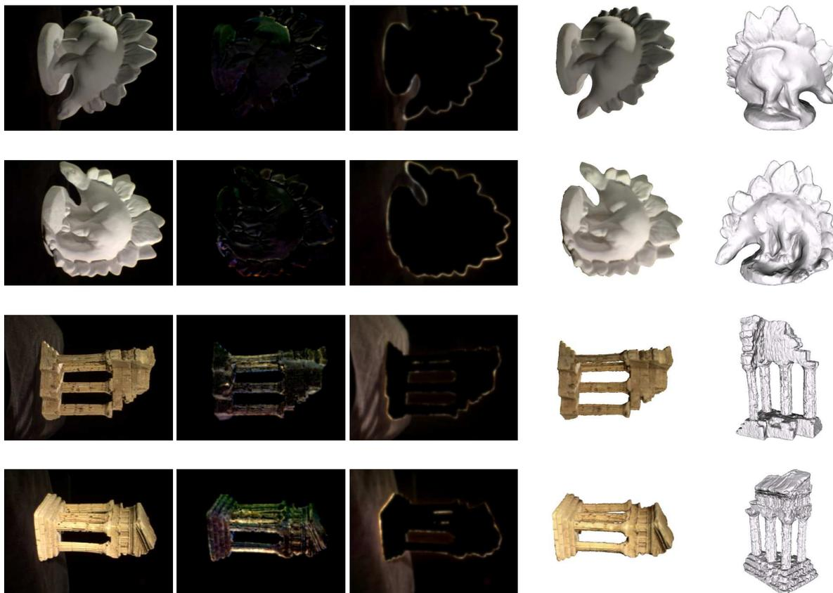
FIG. 6 – Séquences du "Dino" et du "Temple". De gauche à droite : 1 des 16 images d'entrée ; composante corrective non-Lambertienne estimée (multipliée par 8 pour visualisation) ; images de fond estimées (multipliée par 2 pour visualisation) ; radiance estimée ; surface reconstruite vue d'un point de vue différent.
