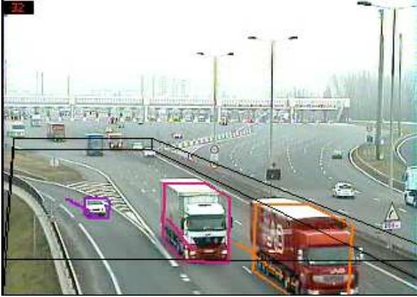
FIGURE 6 – Enveloppe estimée et trajectoire de camions et voitures sur autoroute (la zone de suivi est délimitée par les lignes noires).
