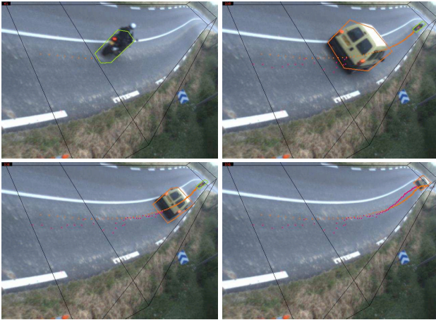
FIGURE 7 – Enveloppe estimée et trajectoires motos et voitures sur route sinueuse.
