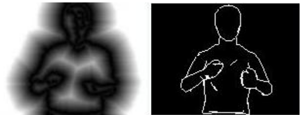
Figure 4 : Distance entre contours. Les images sont respectivement : la carte de distance aux contours et les contours occultants du modèle 3D.
