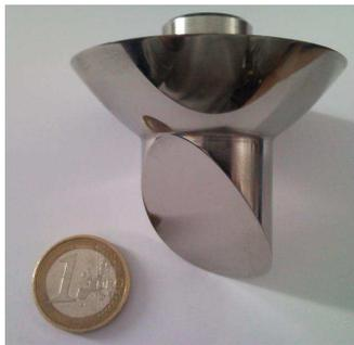
FIG. 8 – Prototype du double miroir.
