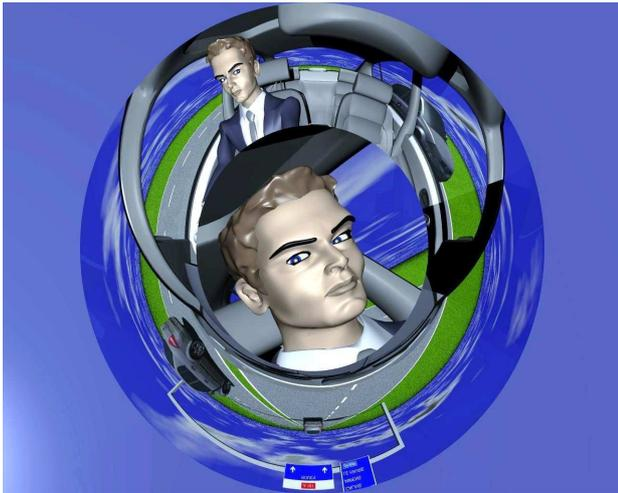
FIG. 7 – Simulation du capteur catadioptrique complet à deux miroirs dans le véhicule pour une vue panoramique de la scène de conduite et une vue à résolution plus élevée pour le visage du conducteur.
