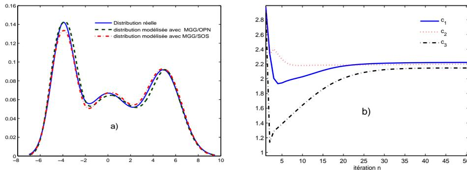
Figure 2: Figure a) montre la densités de probabilité réelle (trait continu) et estimées selon les deux approches proposées d'un mélange de 3 gaussiennes, pour  $N=5000$ . Le résultat d'estimation des paramètres de forme avec la méthode SOS sont  $c_1 = 2.08$ ,  $c_2 = 2.21$ ,  $c_3 = 2.29$ . Figure b) montre la convergence des paramètres obtenue avec la méthode SOS.
