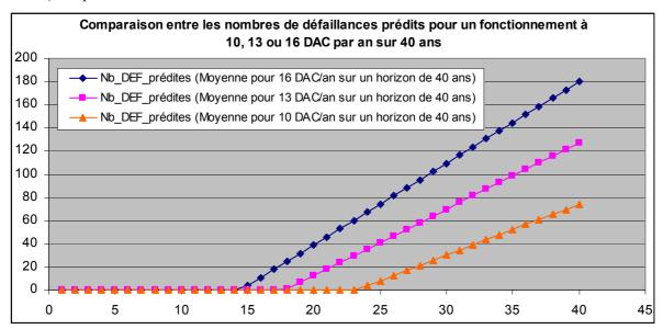
Les modélisations réalisées permettent de quantifier l'impact d'un changement d'exploitation dans la mesure où l'augmentation du nombre annuel de démarrages à chaud injecté dans le modèle du processus de défaillances, permet de quantifier un nombre de défaillances supplémentaire par rapport à une exploitation standard, et par conséquence, une dépense supplémentaire pour l'exploitant (en perte de disponibilité et en frais de réparations).
