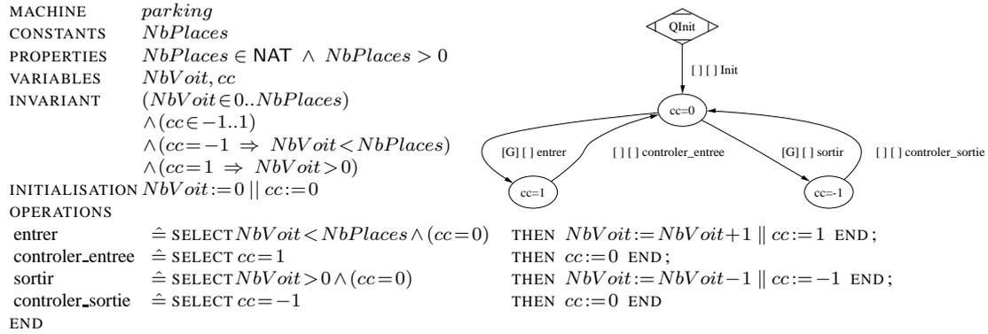
FIGURE 1 – Exemple d'un parking avec contrôleur (inactif) et son système de transitions associé.
