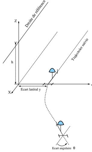
FIG. 10 – Configurations initiale et désirée du robot mobile
