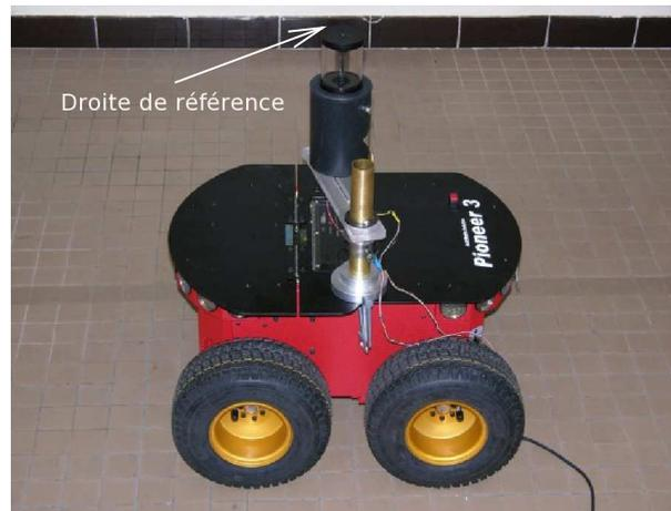
FIG. 13 – Robot mobile Pioneer 3 avec caméra omnidirectionnelle embarquée
