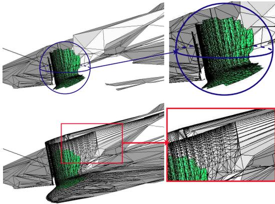
**Figure 6:** Extraction d'isosurfaces au sein du Post pour la RLI seulement (en haut) et avec un unique maillage valide (en bas). La sphère d'intérêt est dessinée en haut à gauche, zoomée en haut à droite. La RLI met en évidence l'écoulement de l'oxygène liquide.
