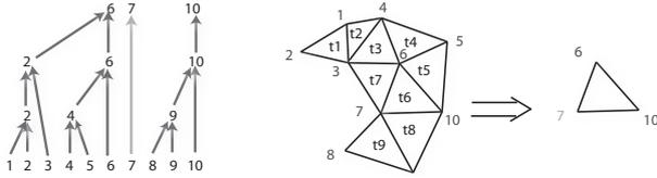
**Figure 1:** *Processus de Simplification.* Les sommets sont regroupés en 3 clusters  $C_0^v = \{1, 2, 3, 4, 5, 6\}$ ,  $C_1^v = \{7\}$  et  $C_2^v = \{8, 9, 10\}$ ; et les triangles dans  $C_0^t = \{t_1, t_2, t_3, t_4, t_5, t_6, t_7\}$ ,  $C_1^t = \{t_6, t_7, t_8, t_9\}$  et  $C_2^t = \{t_5, t_6, t_8, t_9\}$ .
