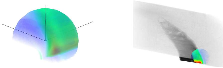
**Figure 8:** Rendu Volumique Direct de l'ensemble de données Blunt Fin. La RLI est placée à proximité du choc où la densité de l'air varie fortement (à gauche). Un point de vue différent montre l'intégration du focus au sein du contexte et permet d'obtenir une compréhension globale (à droite).
