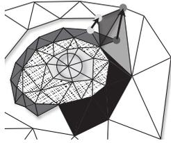
**Figure 4:** Le raccord est en cours de construction. Les triangles fins de lien (gris foncé) sont étirés (en noir) pour relier les deux résolutions et combler le trou. Cela est fait en projetant les sommets fins inactifs sur leur sommet grossier correspondant. Le focus est représenté par le cercle. Les triangles gris clairs et hachurés sont internes et intérieurs, respectivement, alors que les blancs font partie du contexte.
