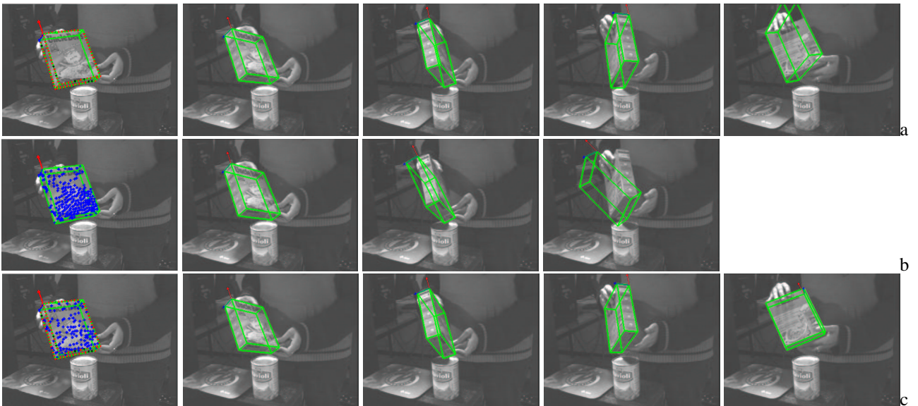
FIG. 5 – Séquence de la boîte de riz. Images pour les suivis (a): basé contour, (b): basé texture, (c): hybride. Seul le suivi hybride réussit à suivre correctement les objets tout au long de la séquence, malgré les reflets et l'environnement.
