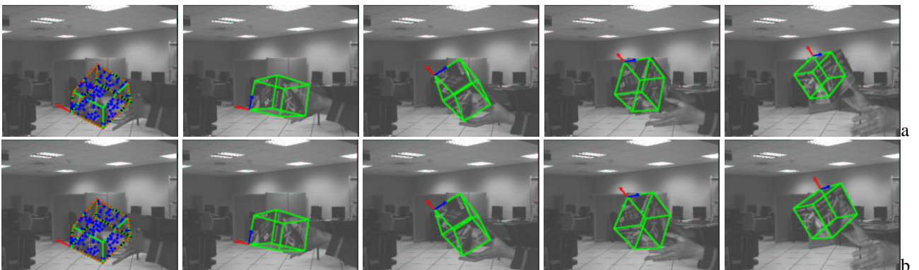
FIG. 6 – Séquence de la boîte de DVD. (a) avec une seule image de référence par face, (b) avec une pyramide d'images par face. Le modèle multi-échelle de la texture améliore les performances du suivi: il permet de prendre en compte la distance caméra-objet courante sans dégrader ralentir le traitement d'image.
